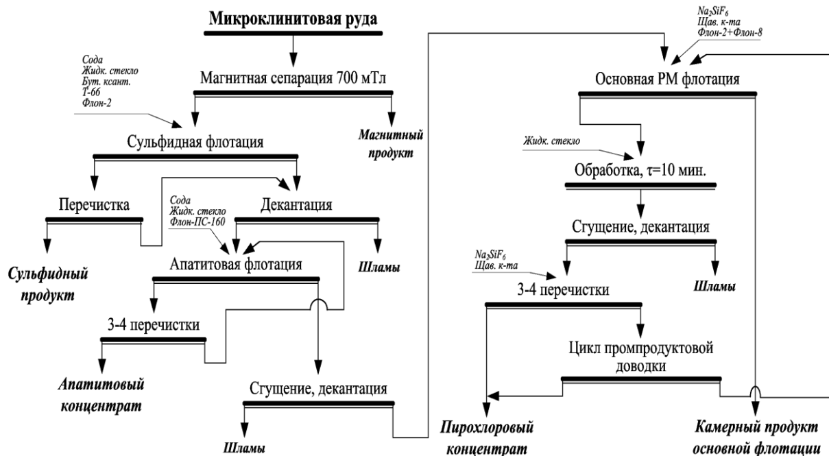
Рисунок 1 - Схема флотационного обогащения руды микроклининового типа
