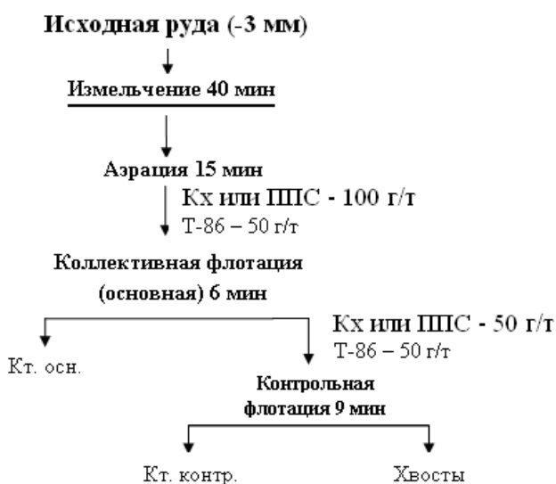
Рисунок 3. Технологическая схема флотации медно-никелевой руды
