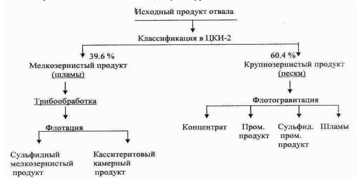
Рисунок – Схема обогащения сульфидно-кварцевых отходов
