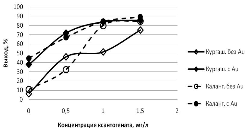
Рисунок 2 - Флотирuemость Кургашиноканского (сплошная линия) и Калангуйского (пунктирная линия) пирита ксантогенатом (рН 9,3)
